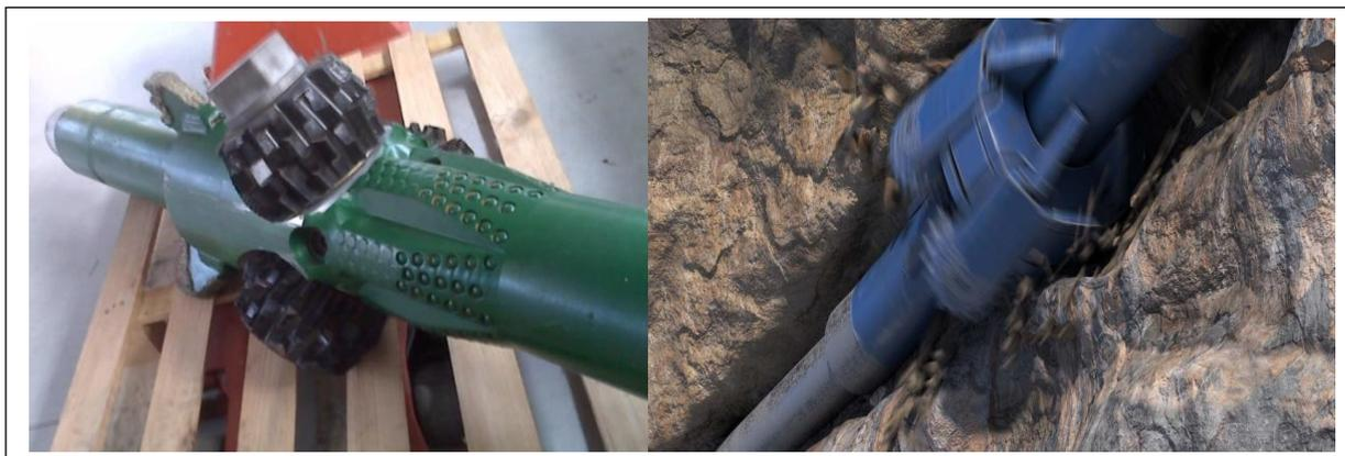
Figura 9: Alesatori del tipo "Hole opener"
